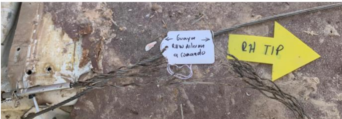
Imagen No. 2 – Condición final de cables de alerón, plano derecho – HK1477
